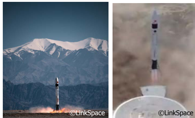
Linkspace社の再使用ロケットのプロトタイプと飛行試験の様子
