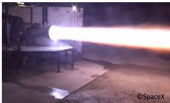
Raptorエンジンの燃焼試験の様子
