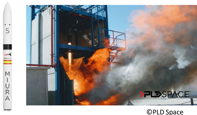
PLD Space社が開発中のMIURA 5 と関連するエンジン試験の様子
