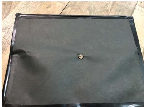
単元の導入に自作の教材を開発した。箱の裏で導線と電池をつなぐと表面に見えている豆電球の明かりがつくものである。本教材は、豆電球が点滅する現象を見ることができるが、箱の裏は児童から見えないため、「箱の裏はどうなっているんだろう」と意欲的に取り組めると考える。
