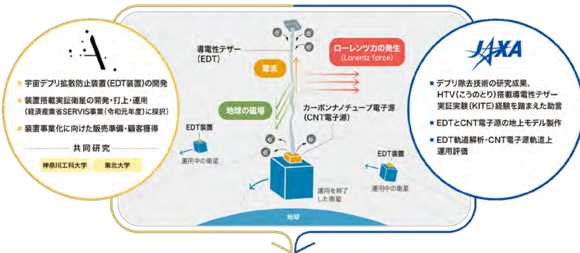
小型衛星に搭載したEDT装置から電気を通すテザー(ひも)を伸展し、軌道離脱 宇宙デブリの拡散を未然に防ぎ、サステイナブルな宇宙開発へ貢献
