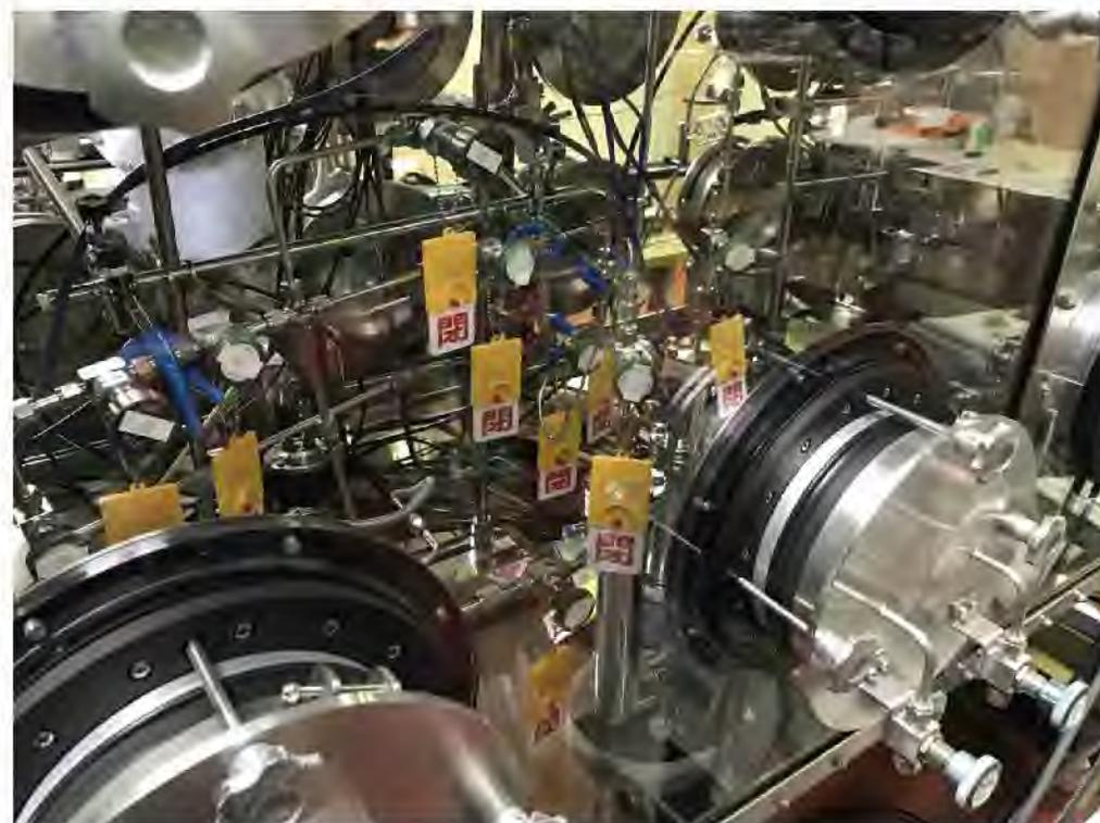
トリチウム酸化及び燃料への充填装置
