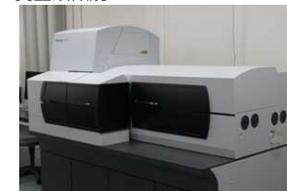
共焦点レーザー走査型顕微鏡
