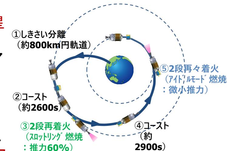
複数衛星を異なる2軌道への投入し、打上げコストの低減・打上げ機会の有効利用を実現 19
