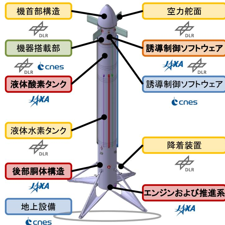
艦装検討用に作成したデジタルモックアップ(機体直径1.1m、全長13.5m)と各機関の主な分担
