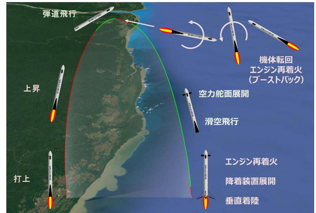
海上(台船)に着陸する飛行プロファイルの検討例(最高高度約36km、最高マッハ数1.6)
