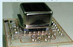
高性能MEMSジャイロスコープ (東北大学)
