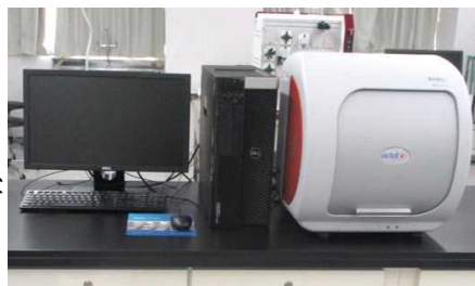
【光電子分光装置】 研究：元素の同時分析や化学状態の把握が可能となり、新たな先端材料の研究開発を実現。
