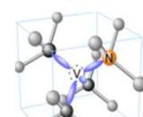
固体量子センサ(ダイヤモンドNVセンサ)
