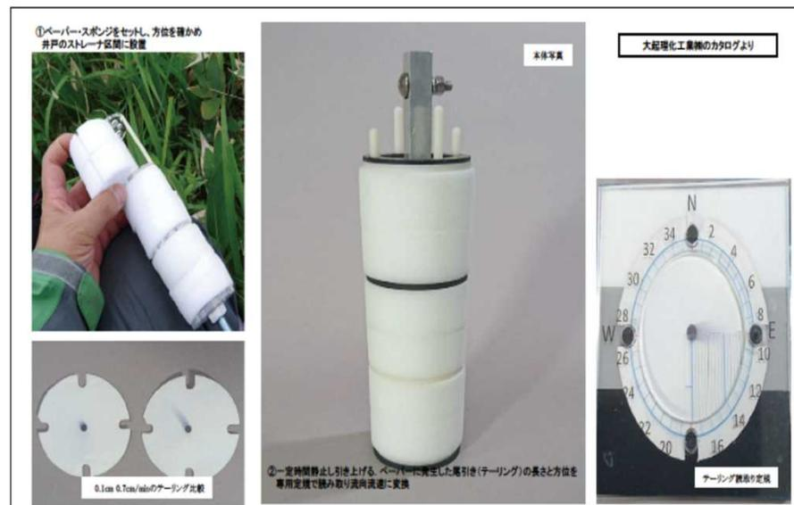
ペーパーディスク型簡易地下水流向流速計
