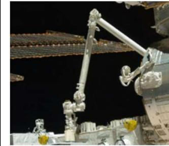
船外実験プラットフォームの実験装置の交換や各種保守作業を行う。
