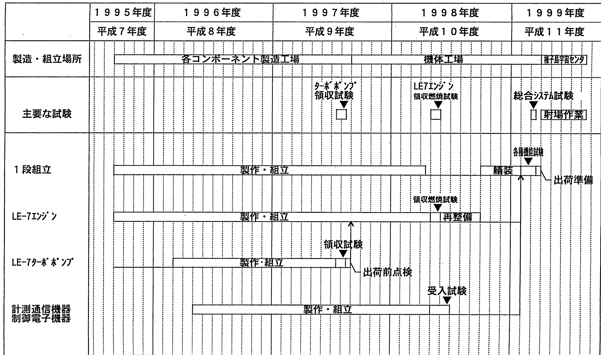
図3.1-1 H-IIロケット8号機 第1段製作スケジュール
