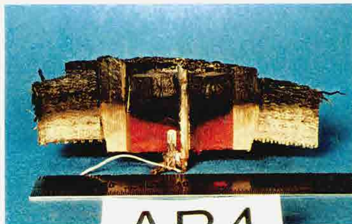
図－５－６ アブレータ供試体断面（機体先端）
