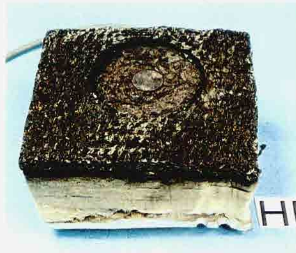
図－５－５ 取り外し後のアブレータ供試体（機体側面）
