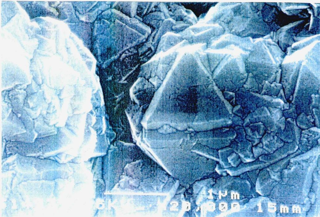
図2.10-2 ダイヤモンド薄膜写真
