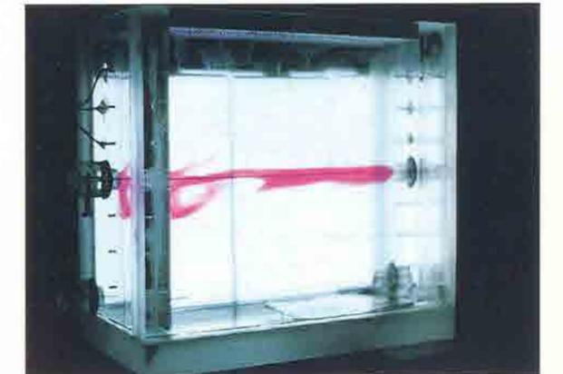
図3 電解発色法の地上模擬試験
