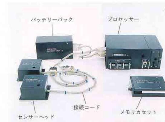
加速度計測装置
