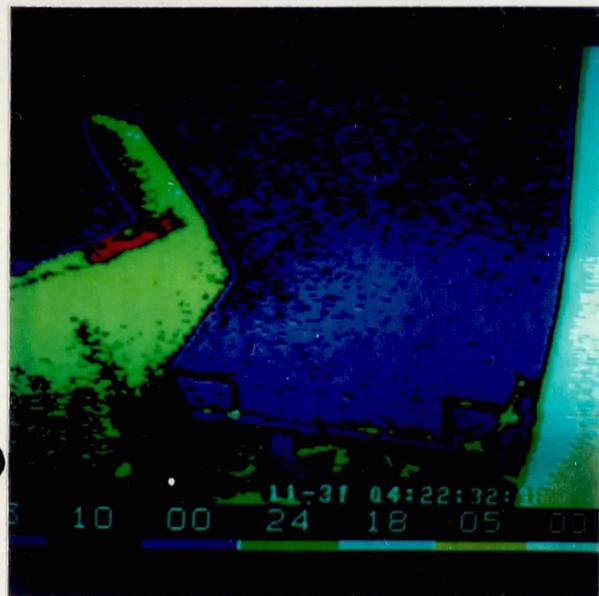
電子ビーム放出時のパレット機器の発光(TV観測例)、ビーム放出に伴いオービタ帯電のため、高速電子がパレット機器に衝突し発光する。この励起光強度が帯電強度の指標となる。
