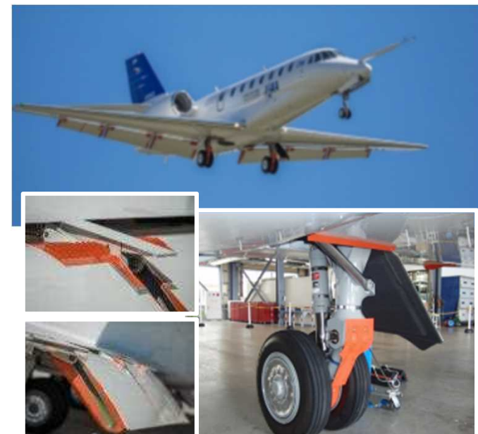
低騒音化設計に基づき改造（赤色箇所）した実験用航空機「飛翔」 12
