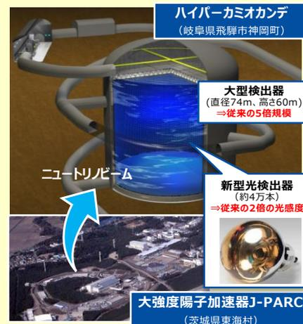
日本が切り拓いてきた**ニュートリノ研究の次世代計画**として、**超高感度光検出器**を備えた総重量26万トンの**大型検出器の建設**及び**J-PARCの高度化**により、**ニュートリノの検出性能を著しく向上**。素粒子物理学の大統一理論の鍵となる未発見の**陽子崩壊探索**や**CP対称性の破れ**などの**ニュートリノ研究**を通じ、**新たな物理法則の発見、素粒子と宇宙の謎の解明を目指す**。[ロードマップ2017掲載事業]
