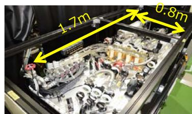
高出力レーザー用の熱歪み低減技術を用いて5J,50Hzの屋外使用可能な小型YAGレーザーを開発。
