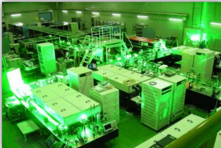
**高強度チタンサファイヤレーザー装置
