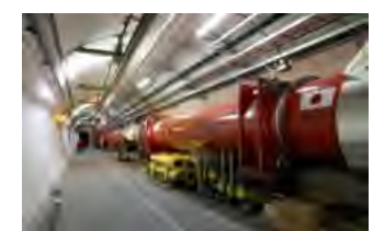
陽子ビームの衝突頻度の向上に重要な役割を果たすLHCビーム衝突点超伝導磁石
