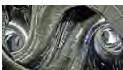
◆大型ヘリカル装置内部の真空容器 直径30センチメートル、長さ10メートル以上のプラズマを閉じ込める
