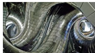
◆大型ヘリカル装置内部の真空容器 体積30立方メートル、温度1億度以上のプラズマを閉じ込める
