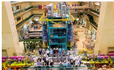
衝突点付近のSuperKEKB加速器(手前)とアップグレード作業中のBelle測定器(奥)
