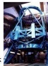
晴天率が高く、大気による揺らぎが少ないマウナケア山頂4,200mの高地に設置。一枚鏡としては世界最大級の口径8.2mの反射鏡を有する光学望遠鏡。大気による像の揺らぎを打ち消す補償光学装置及び超広視野主焦点カメラ(HSC)の開発により、ハッブル宇宙望遠鏡をしのぐ高解像度、高精度の画像を得ることができる。
