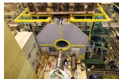
Belle IIとQCS（ビーム衝突点用超伝導電磁石）。QCS内部には衝突点直前でビームを絞るために様々な種類の超伝導電磁石が組み込まれている。
