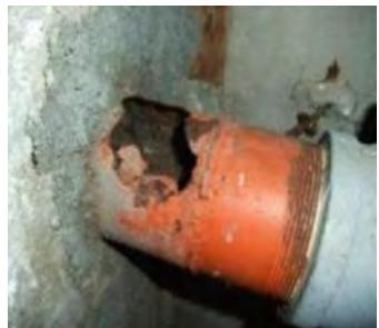
劣化による配管破損
