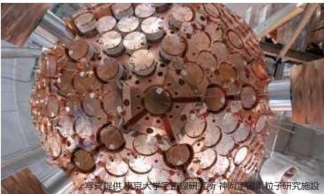
液体キセノンが入っている検出器の中心部分。円盤一つ一つが光電子増倍管とつながっている。
