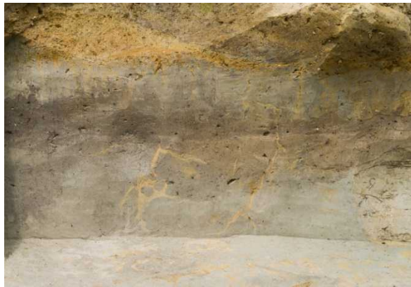
平城第530次発掘調査地で発見された 噴砂痕跡の写真
