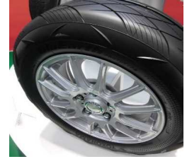
自動車用タイヤ空力形状設計: 空気抵抗と揚力を同時に低減できる画期的な形状を発見。右図は東京モーターショー2015で展示された試作品
