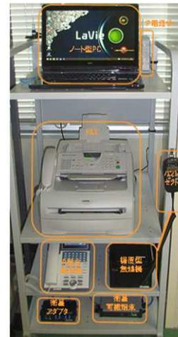
図1: IP 電話・PC 等と連携した衛星携帯電話ユニット(基地局)
