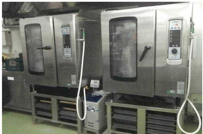
図3: 非常電源供給で稼働するコンベクションオープン
