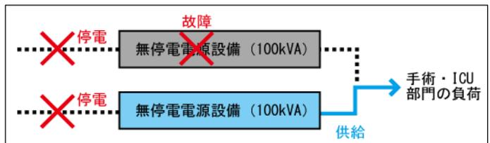
図3:無停電電源設備の冗長化の概念図
