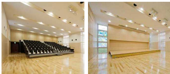
図7: 観客席が収納可能な多目的ホール(左:収納前、右:収納後)
