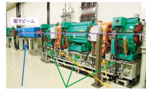
電子ビーム 偏向電磁石 (88台) 電子ビームの軌道を曲げる(1台で約4度) 4極電磁石 (470台) 電子ビームの散逸を防ぎしぼる 6極電磁石 (300台) 4極電磁石の働きを助けて電子ビームの安定性を高める
