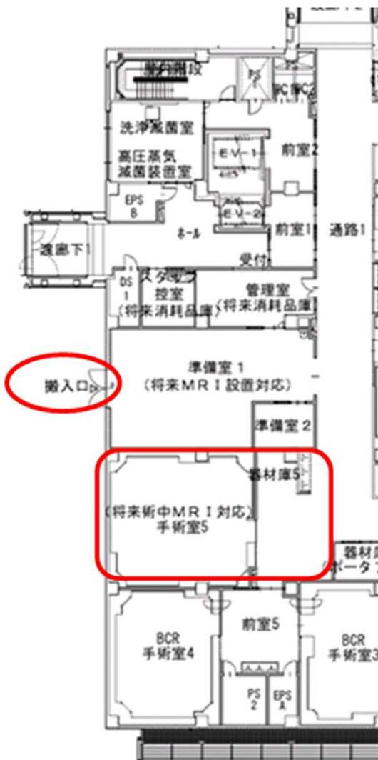
図4 医療機器搬入のための外部搬入口を設置
