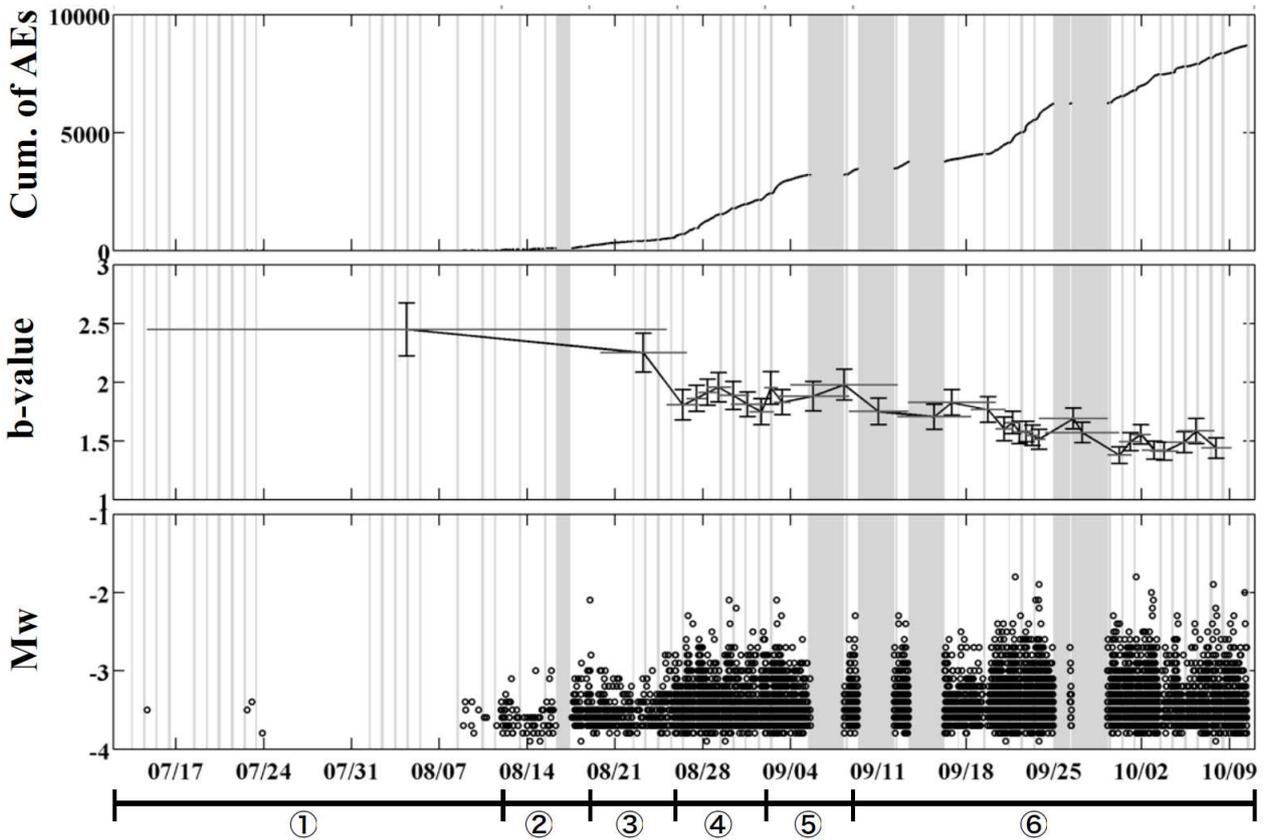
図7. 南アフリカ金鉱山において採掘前線の前方20mの地点に新出した微小破壊の平面状クラスター。
