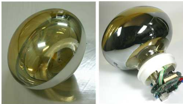
8インチの大口径ハイブリッド型光検出器 (HPD)
