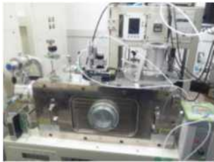
ポンプ-プローブ型時間分解FUV分光装置
