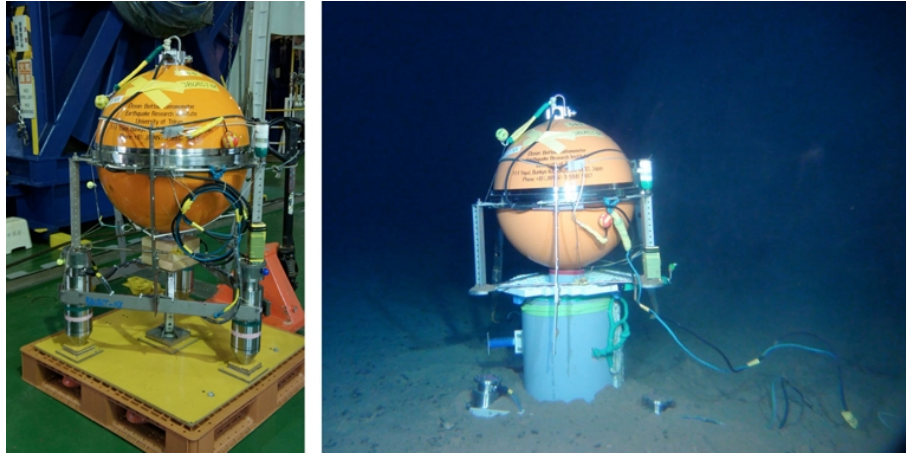
図4 BBOBS-NX の高機能化への基礎試験
