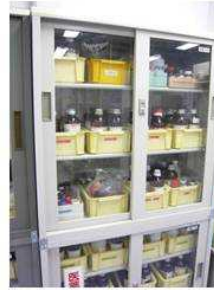
地震時に薬品ビンが破損しないよう、仕切りがあるケースに保管
