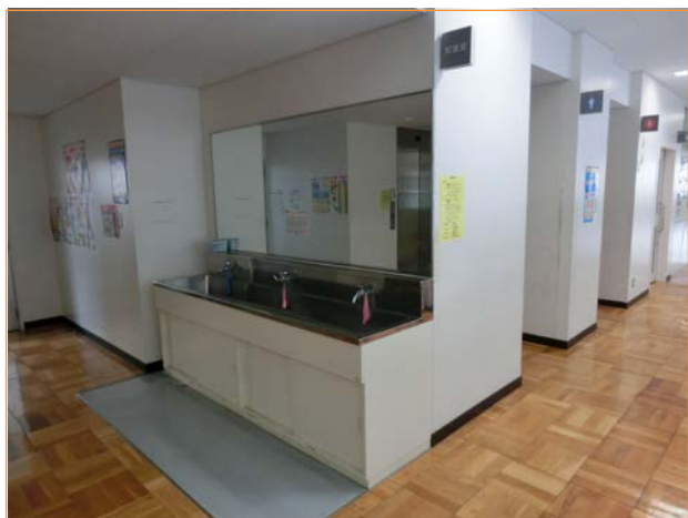
写真：通行の妨げとならないように配慮し、廊下に面した手洗いはコーナーに設置。
