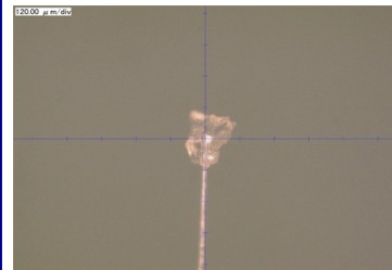
イトカワ微粒子. 直径5μmのカーボンファイバーの先に樹脂で接着
