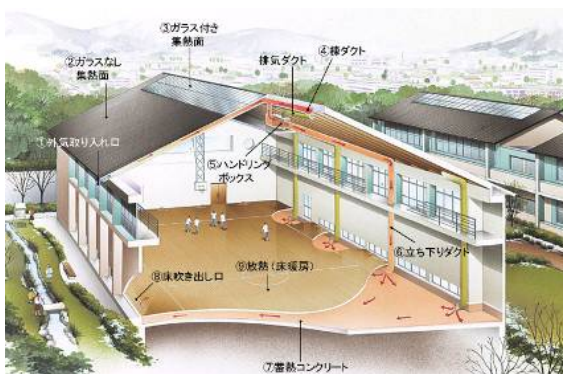
<東京都目黒区立目黒中央中学校> 太陽熱を利用した床暖房の概念図
