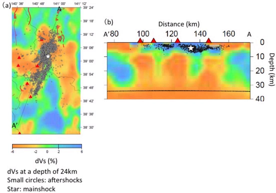
図 9. 岩手・宮城内陸地震震源域周辺の S 波速度偏差分布（東北大学 [課題番号：1207]）。(a) 深さ 24km における平面図。白☆は本震を、小○は余震、赤▲は第四紀火山の位置。(b) 図(a)中 A-A' に沿う鉛直断面図。深さ 35km 付近の線はモホ面。
