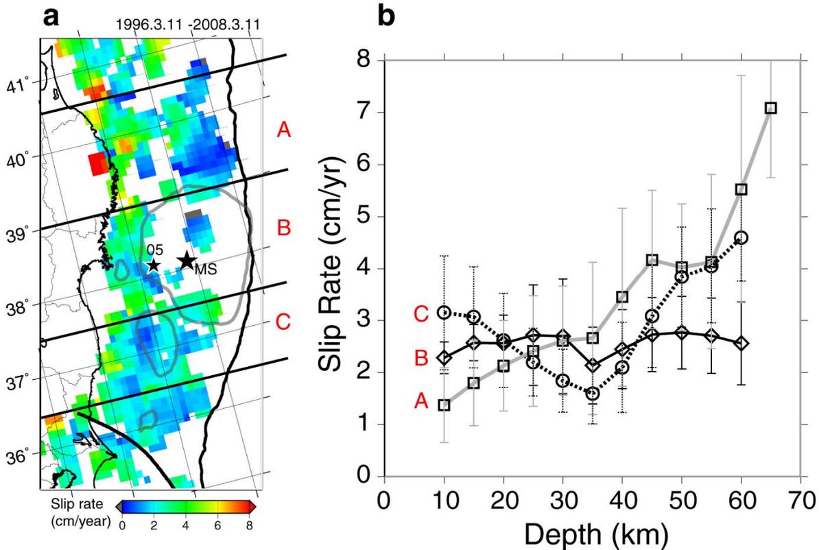
図1. 小繰り返し地震解析による東北地方太平洋沖地震発生前のプレート間非地震性滑り（東北大学 [課題番号：1205]）。(a) 2011年東北地方太平洋沖地震震源域周辺の地震前の非地震的滑りの速度分布。1996年から2008年について、 $0.3^\circ \times 0.3^\circ$  のグリッドごとに、その中の繰り返し地震の滑りレートの平均を示す。A-Cは(b)で深さごとの滑りレートを推定した領域。灰色コンターはIinuma et al. (2012)により推定された2011年東北地方太平洋沖地震の10mの地震時滑りを示す。(b) 1997年から2011年東北地方太平洋沖地震直前までの非地震性滑りレートの深さ分布。(a)のグリッドについて、プレート境界の深さをZhao et al. (1997)のプレートモデルにより求めた。次に、深さ5kmごとに、その深さから5kmの深さ範囲に対応するグリッドについて、滑りレートの平均（四角，菱形，丸）および標準偏差（エラーバー）を求めた。大滑り域の北部(A)，大滑り域が含まれる場所(B)，大滑り域の南部(C)（(a)参照）について示す。
