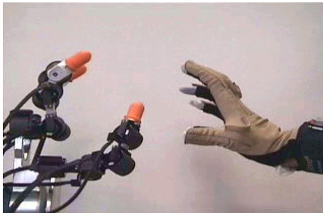
図 15：マスター・スレーブ型遠隔操作ロボットハンド
