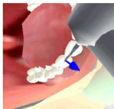
図 12：切削反力の可視化と提示
