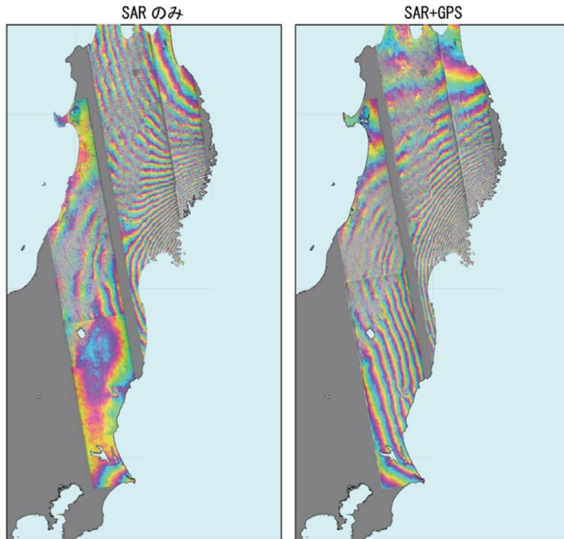
図6. GPS データ統合解析手法の適用効果 (Kobayashi et al. (2011) のFig. 2 を一部改変)。
