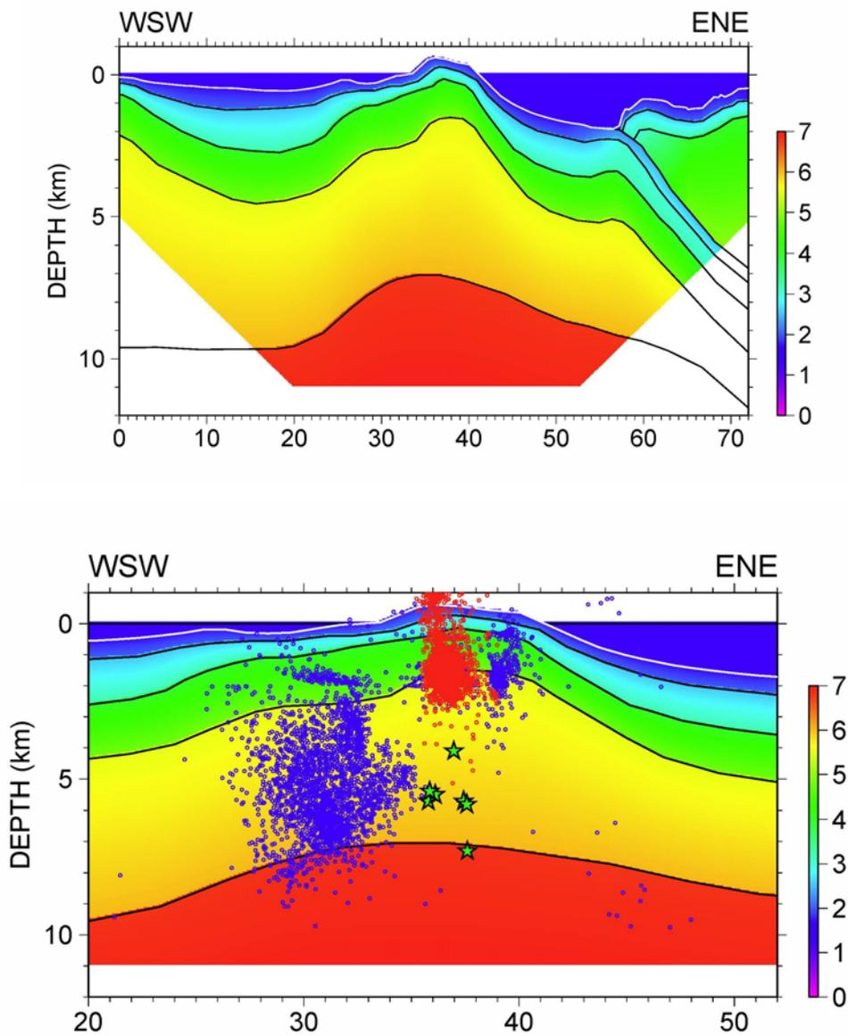
図 13. 2009 年伊豆大島構造探査により得られた速度構造と地震活動の関係（東京大学地震研究所 [課題番号：1413]）。上：エアガンと海中発破からのデータを用いて決定された P 波速度構造。下：伊豆大島におけるカルデラ内の地震（赤丸）、周辺部の構造的な地震（青丸）、マグマ貫入時及び後退時における圧力源の位置（星印）と地震波速度構造の関係。速度構造については上図中央部のクローズアップとなっているが縦横比が違うことに注意。
