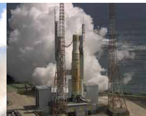
第1段実機型タンクステージ燃焼試験
