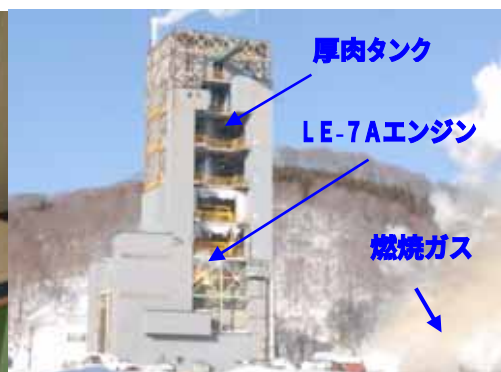
厚肉タンクステージ燃焼試験
