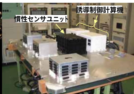
誘導制御系システム試験
