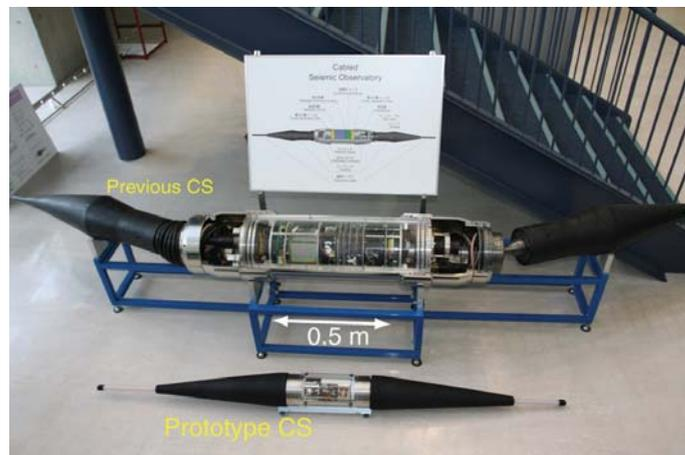
新規に開発した観測ノード（下）と従来の観測ノード（上）。最新エレクトロニクス技術の利用により、大幅な小型化に成功した。観測ノードの小型化により、製作費を下げることもできただけでなく、海底への設置・敷設が容易になった。
