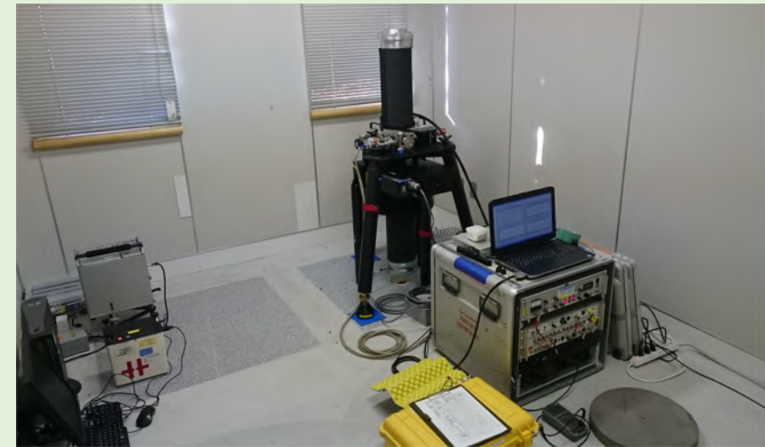
図5 2019年度に富士山科学研究所内に整備された重力観測室。写真は国土地理院による絶対重力観測の様子。
