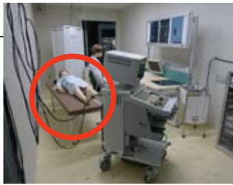
▲診察デスクや超音波画像診断装置（比較的重量のある医療機器）が移動。診察台の患者も大きく移動した
