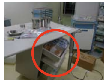
▲薬のトレイがワゴンから飛び出して落下。バランスが悪くなったワゴン自体も転倒
