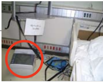
▲衝撃によってモニターが落下
