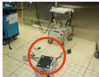
▲キャスター付きの機器が衝突し、転倒・落下
