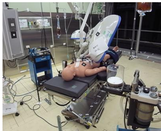
写真 2：試験体内の手術室では、手術台にマネキンを固定し振動実験を行った
