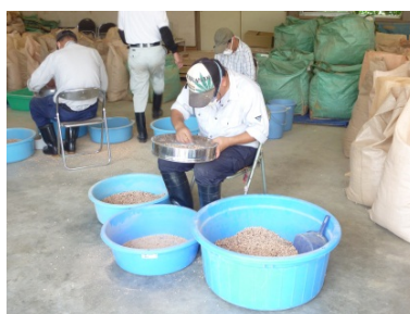
町内のペレット製造工場 （ペレット製造後にふるいに掛け 大きさを整えている）
