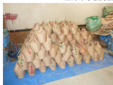
製造されたペレット （1袋：約10kg＝ペレットストーブ1台 が1日暖房する際の使用量）
