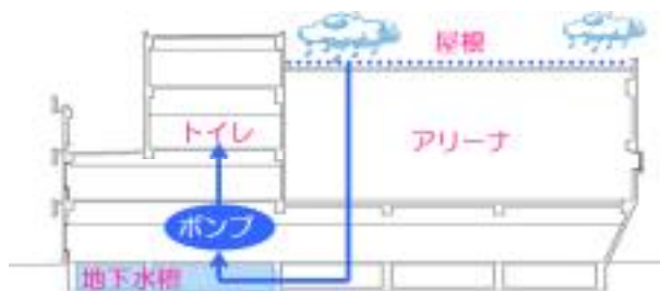
図表 2-2-3 アリーナの屋根に降った雨をポンプでくみ上げ、 トイレの洗浄に利用（東京都江戸川区立松江小学校） （江戸川区提供）
